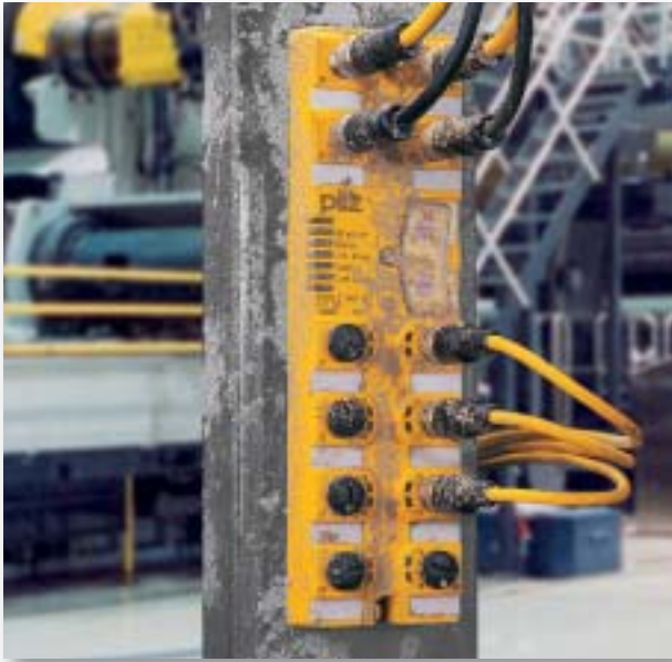
PSS67, resistente a la suciedad y al agua según IP67.
